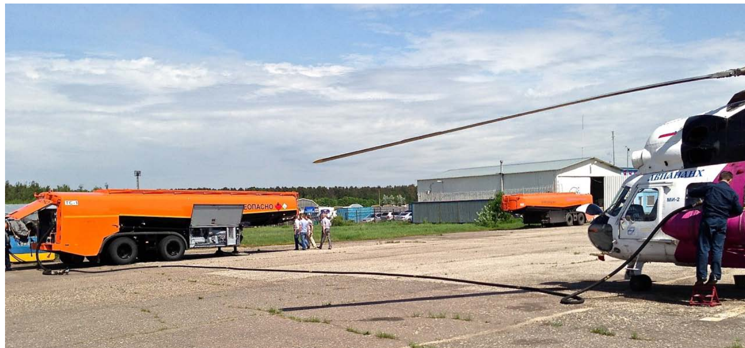
Фото 3. Заправка вертолета с использованием аэродромного топливозаправщика – цистерны-полуприцепа типа ТЗА-24 с автономным дизелем («мобильный склад 24 куб. м на колесах»)
