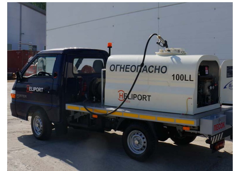
Фото 8. Установка заправки с цистерной 920 литров на шасси
